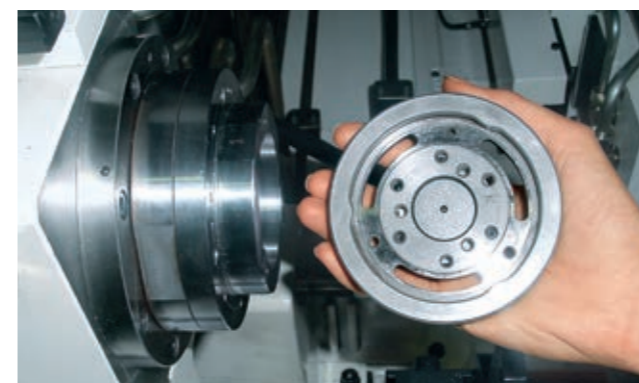
Schneller Wechsel des Auf- und Mitnehmers durch das 3-Punkt-Aufnahmesystem
