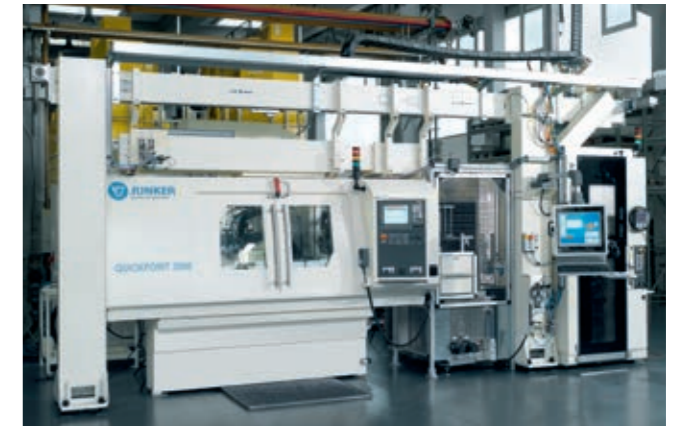
QUICKPOINT mit Automatisierung
