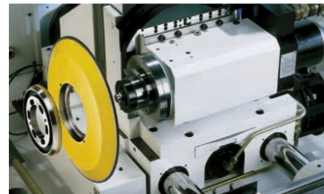
Schneller Wechsel des Auf- und Mitnehmers durch das 3-Punkt-Aufnahmesystem
