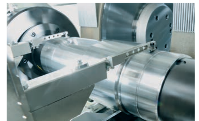
Inprozess-Messung für höchste Fertigungsgenauigkeit
